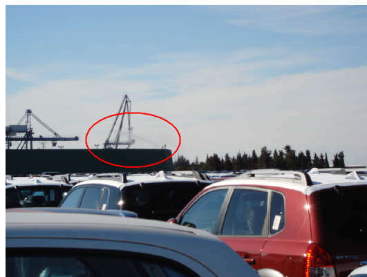
Slika 4.21: Konstantno polivanje razsutega tovara z vodo je označeno z rdečo. Žal ob močnem vetru tudi to ne koristi, da premoga ne bi odnašalo.
