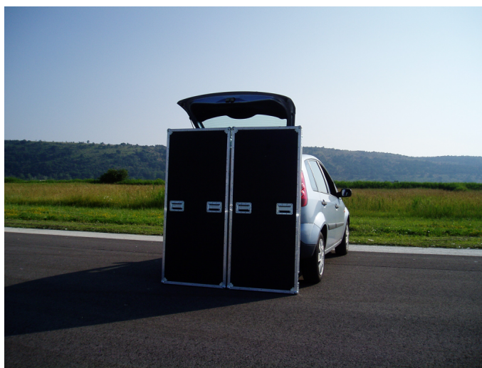
Slika 4.25: Za premično tarčo smo nameravali uporabiti kar dve večji plošči postavljeni skupaj prislonjeni na avto, ki bi ga oddaljevali od lidarja. Foto: Nataša Grlj.
