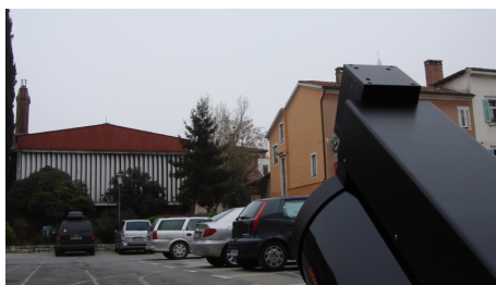
Slika 4.3: Merjenje pred stavbo Primorskega inštituta za naravoslovne in tehnične vede. Megla je celoten signal popolnoma zabila.
